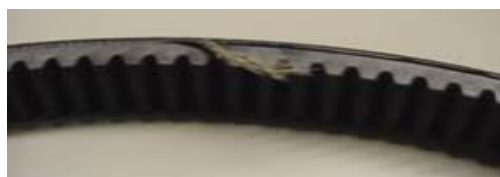
Belt edge cord broken
